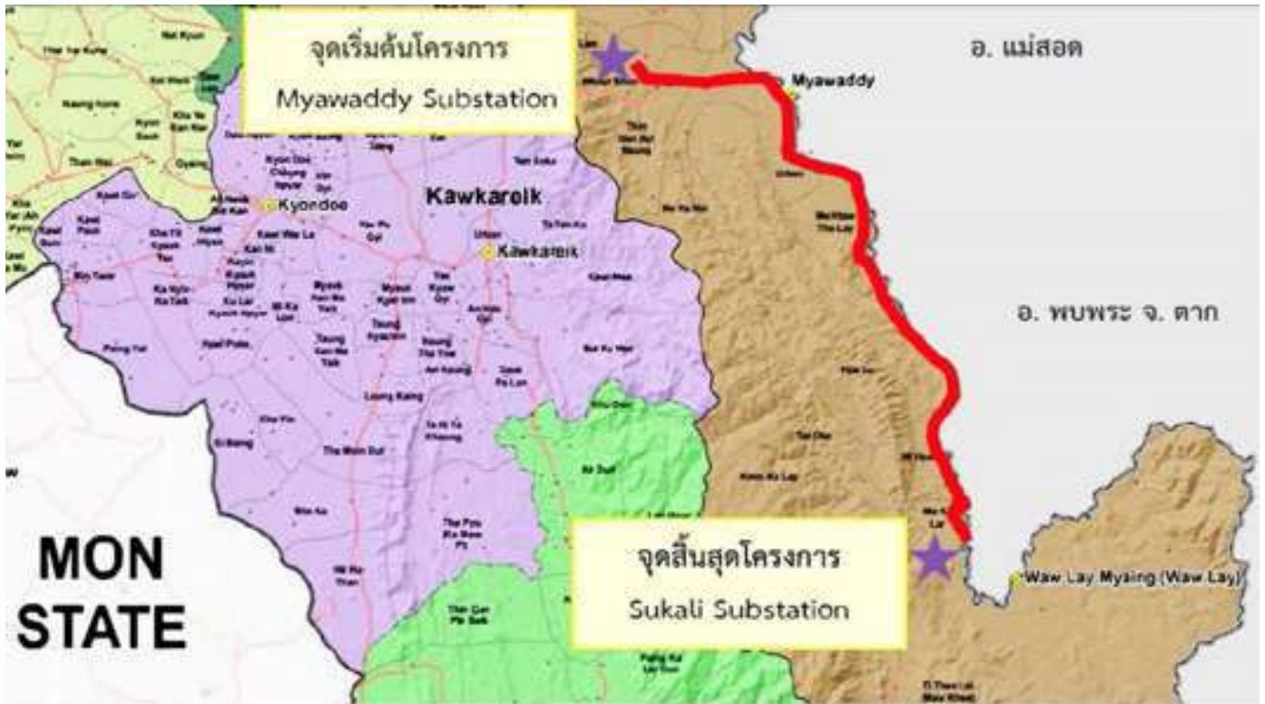
รูปภาพแสดงพื้นที่การดำเนินงานออกแบบรายละเอียดโครงการก่อสร้างสายส่ง 66 kV จากสถานีไฟฟ้าอ้อยเมียวดี ถึงสถานีไฟฟ้าอ้อยสุคาลี การก่อสร้างสถานีไฟฟ้าอ้อยสุคาลี 66/22 kV และการปรับปรุงสถานีไฟฟ้าอ้อยเมียวดี 230 kV ในจังหวัดเมียวดี
